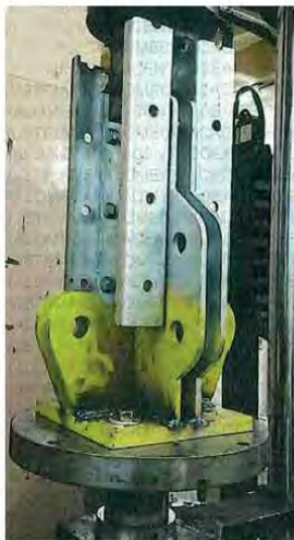
Figura 4. Ensaio de tração da Sapata SHORFLEX® HD 2C
